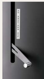
Um nach dem Anheizen möglichst schnell die optimale Brennraumtemperatur zu erreichen, wird die Anheizklappe geöffnet. Die Abgase strömen ohne großen Widerstand an dem Wärmetauscher vorbei. Dadurch entsteht ein höherer Zug und somit eine stärkere Sauerstoffzufuhr. Wenn nach einigen Minuten die Anheizklappe wieder geschlossen wird, entfaltet sich der volle Wirkungsgrad des Kaminofens.
